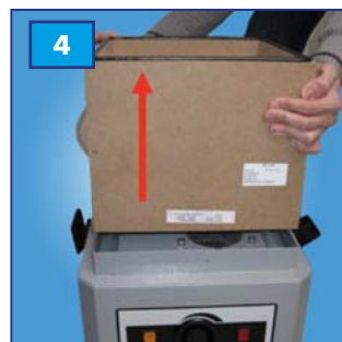
4. Neem het verzadigde filter uit en plaats een nieuw filter op dezelfde wijze
