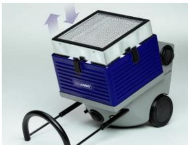
De afbeelding geeft de werkwijze aan voor het wisselen van de filtercassette. Vooraf dient de stekker uit het stopcontact genomen te worden en de aanzuig-aansluiting losgekoppeld te worden. Het grijze aansluitdeksel afnemen door de spansluitingen te ontkoppelen.
