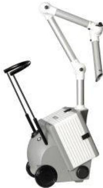
Bij gebruik van een Alsident afzuigarm is de arm in elke gewenste positie te plaatsen. Let bij plaatsing van de arm op de juiste stand van de arm. De schroefjes op het laatste scharnier dienen in het aangezicht van de arm te zitten. Zitten de schroefjes aan de onderzijde dan is de arm verkeerd om gemonteerd. Dit kan mogelijke beschadiging van de veer in het eerste scharnier tot gevolg hebben waardoor de arm niet meer goed te positioneren is.
